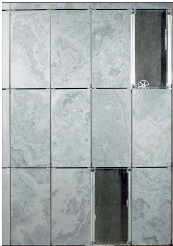
Symmetrische Deckung 600 x 300 mm, vertikal verlegt, auf Alu-UK sichtbar geklammert mit Edelstahl-Befestigungsklammer HE130
