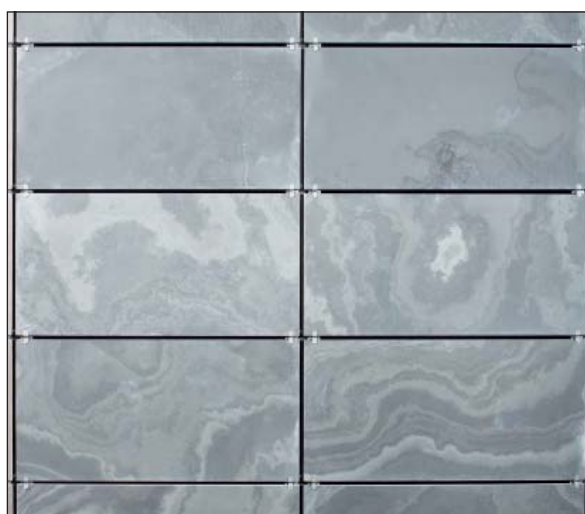
Symmetrische Deckung 600 x 300 mm, horizontal verlegt, auf Alu-UK sichtbar geklammert mit Edelstahl-Befestigungsklammer HE130
